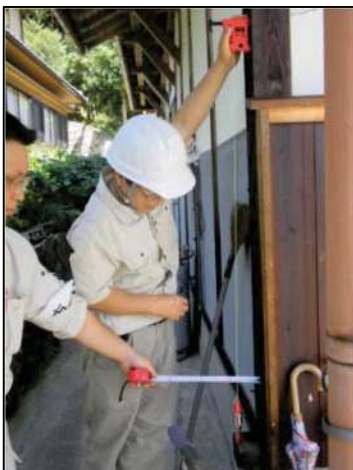
◀家の傾斜を測定している写真の例
