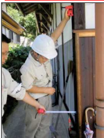
◀家の傾斜を測定している写真の例
